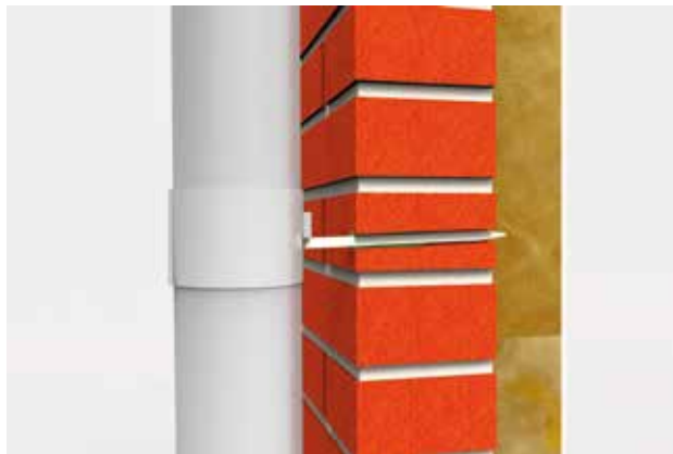
Exempel på stiftsvep vid tegelfasad för infästning av stuprör. Stiftet ska luta lite nedåt.
