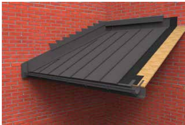
Falsat plåttak med trappad ståndskiva mot tegelfasad. Inpassade trappningsplåtar ska utföras med hake i fog och infästs med kontinuerligt fästbleck samt infästning i hake. Plåthake i fog ska efterlagas med murbruk eller mjukfogas. Skyddsbeslag ska utföras vid hängränngaveln.
