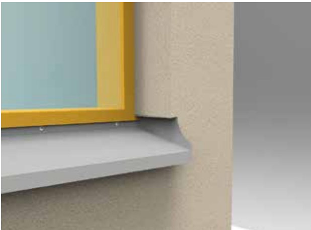
Fönsterbleck med horisontell putsgavel. Horisontella putsgavlar bör utföras vid restaureringsarbeten på kulturklassificerade byggnader eller om så önskas av beställaren.
