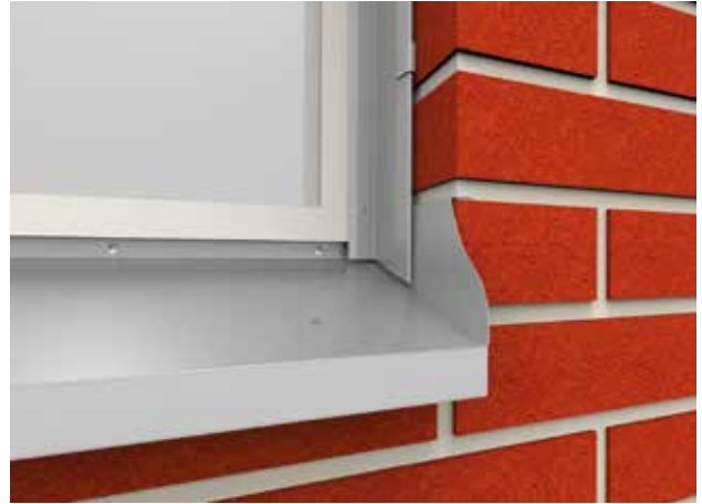
Fönsterbleck vid tegelfasad. Här gestaltat med horisontell gavel och smyglist. Smyglist ska avslutas parallellt med fönsterblecket.
