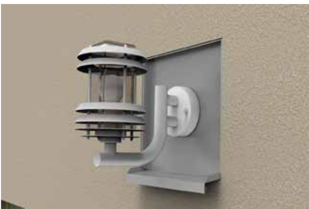
Exempel på skyddsbeslag bakom armaturer och liknande.
