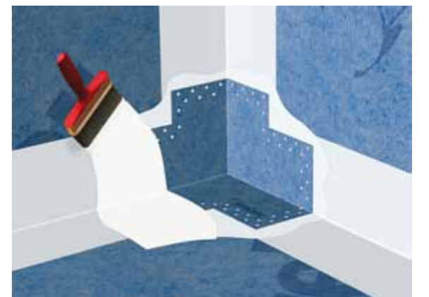
Bild M: Pensla ytan för inner- och ytterhörn med Tec 2 och montera därefter Tec Inner- och Ytterhörn.
