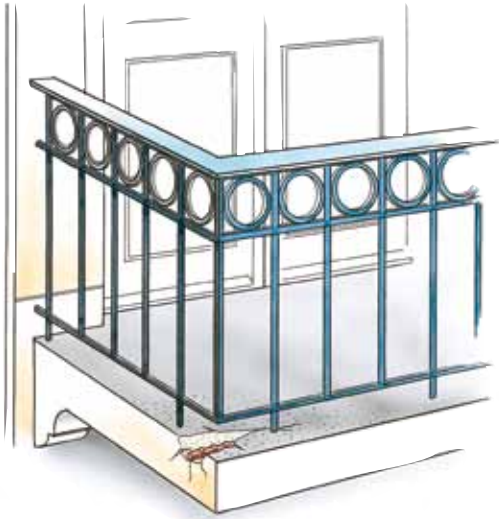
1. Exempel på skadad betongkonstruktion.
